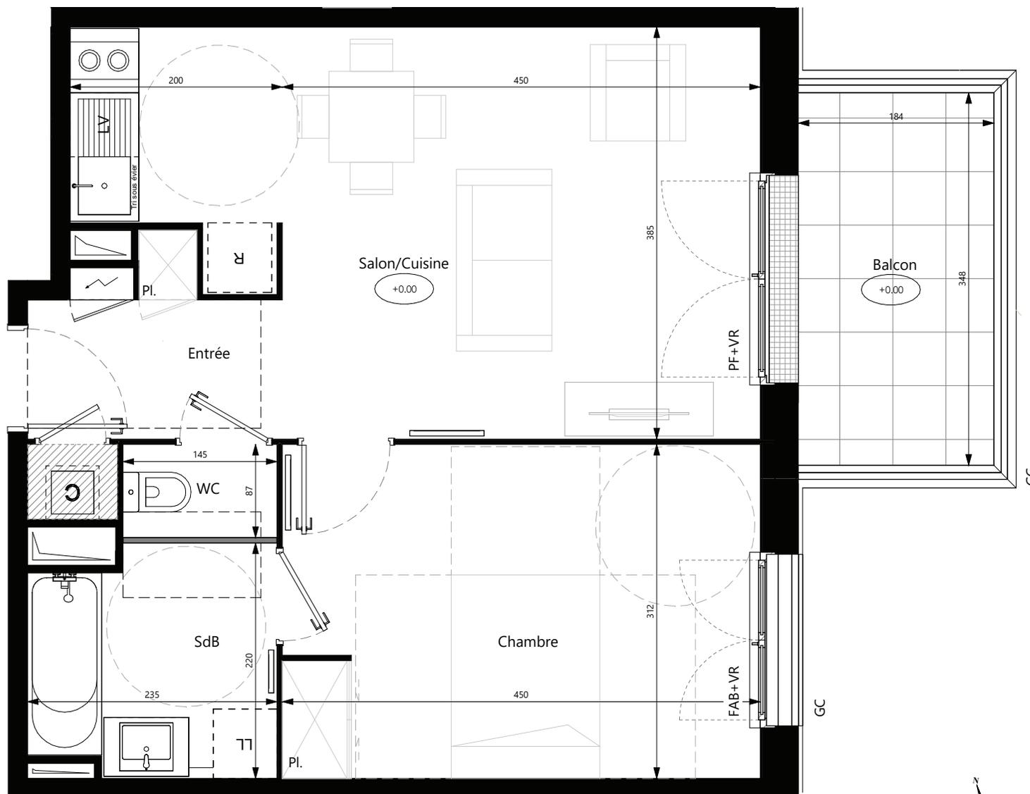
LEGENDE: PF: Porte-Fenêtre / F: Fenêtre / FAB: Fenêtre Allège Basse / VR: Volet roulant / AV: Allège Vitrée / GC: Garde-corps / Pl.: Placard / R: Réfrigérateur / LL: Emplacement Lave-linge / LV: Emplacement Lave-vaisselle / C: Chaudière gaz / Niveau: (+0.20) / HSP: Hauteur sous plafond / Tableau électrique: [Symbol] / Soffites, faux plafonds: [Symbol]
