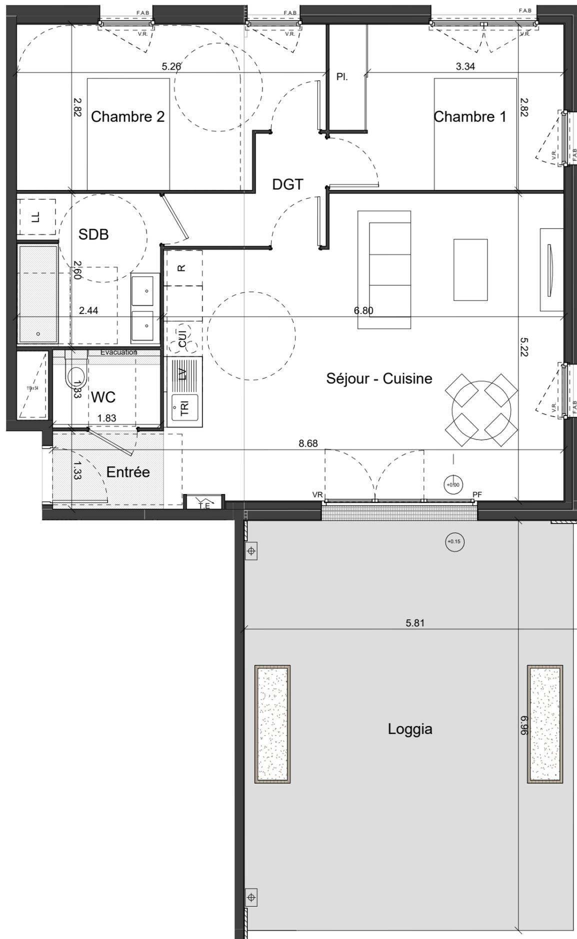
LÉGENDE : P.F. : Porte Fenêtre / F. : Fenêtre / F.A.B. : Fenêtre Allège Basse / V.R. : Volet Roulant / T.E. : Tableau Électrique / PL. : Placard / CUI. : Cuisson / R. : Réfrigérateur / L.L. : Lave Linge / L.V. : Lave Vaisselle / Soffite, faux plafond / Niveau <sup>(+0.00)</sup>
